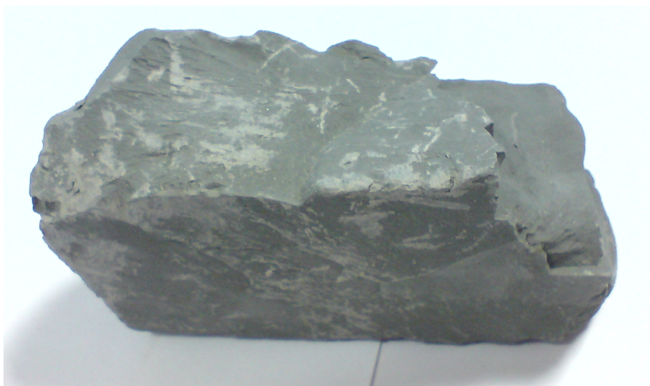
Échantillon (11 x 5 x 4 cm) de l'argilite du Callovo-Oxfordien prélevé à moins 490 mètres lors de la visite, 3 juillet 2009, à Bure
